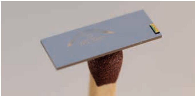
Hybrid PICs für die Sensorik: Mini-Spektrometer auf InP/Polymer-Basis als Interrogator für Faser Bragg-Gitter-Netze © Fraunhofer HHI
