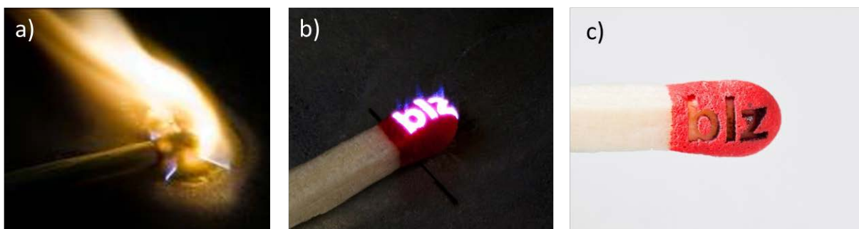
Bild 5: Selektiver Laserstrahlabtrag mit einem UKP-Lasersystem: a) thermischer Prozess und b) „kalter“ Prozess mit c) Bearbeitungsergebnis des „kalten“ Prozesses
